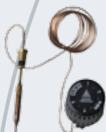
17 Termostatisk reguleringsventil RAVK – til indstilling af varmtvandstemperaturen. Bør indstilles til ca. 50-55 grader svarende til ca. 3,5-4 på ventilen.
