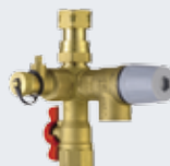
32 Sikkerhedsaggregat Indeholder kontraventil, afspærrings- og sikkerhedsventil. Sikkerhedsventilen skal aktiveres min. hvert halve år, for at undgå tilkalkninger. Ventilen skal dryppe ved opvarmning.
