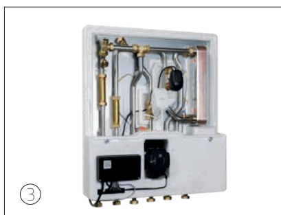
3. Når forpladen er fjernet, er der let adgang til alle unittens komponenter. Er der brug for adgang bag den øverste isolering kan denne fjernes via håndtagene i siderne efter afmontering af styring og energimåler.
