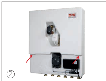
2. Når unitten er taget op af emballagen, aftages isoleringsforpladen forsigtigt via de to håndtag i bunden af den øverste forplade.
