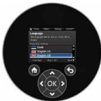
Betjeningspanel på pumpen
