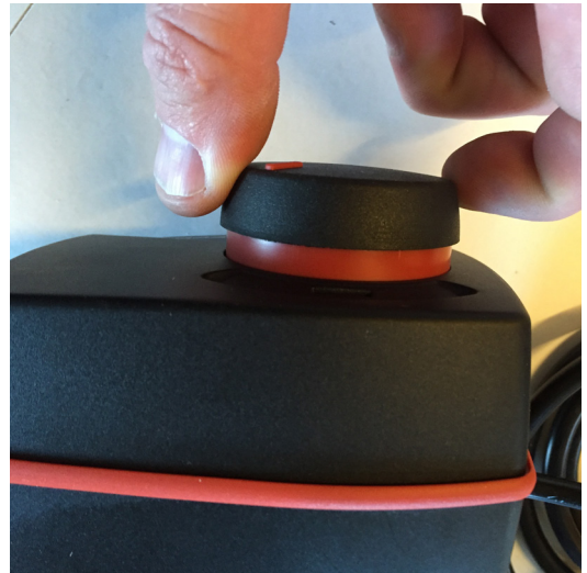
Ved at trække i omskifteren kan denne køre manuelt.
