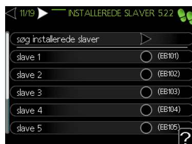
Billede 11 Er der monteret flere varmepumper, tryk Søg installerede slaver
