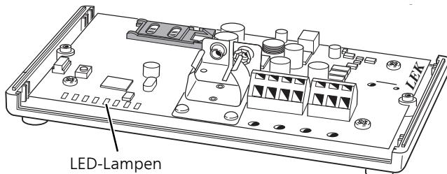
Die Zubehörplatine (AA9) in MODBUS 40 besitzt für eine einfache Kontrolle und Fehlersuche acht LED-Lampen.
