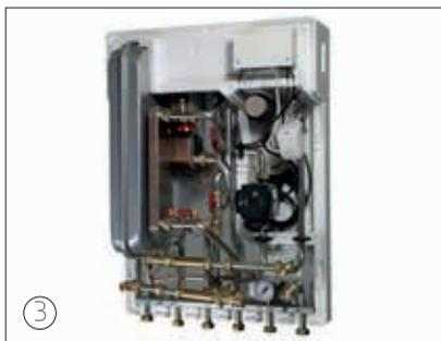
3. Når forpladen er fjernet, er der let adgang til alle unittens komponenter (her vist med Kamstrup energimåler, medfølger ikke). Er der brug for adgang bag den øverste isolering kan denne fjernes via håndtagene i siderne efter afmontering af styring og energimåler.
